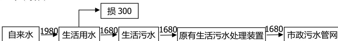
图 2-1 本项目水平衡图 单位: t/a
