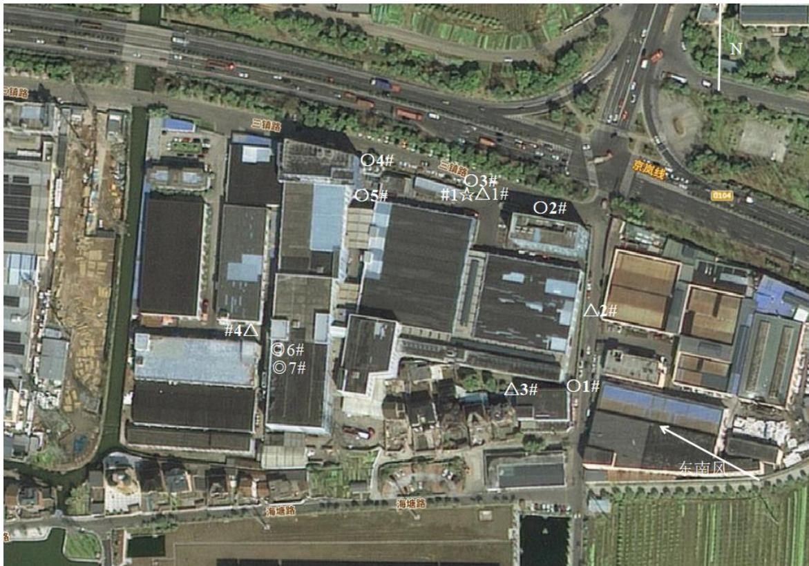
注: ☆为废水监测/采样点, ◎有组织废气采样点, △厂界噪声测点, ○为无组织监测点。
