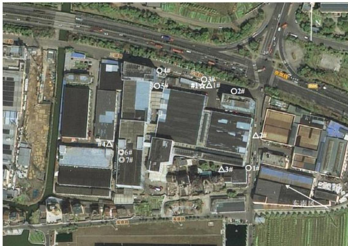
图例: ☆-废水检测/采样点; ◎-有组织废气采样点; △-噪声检测点; ○-无组织废气采样点
