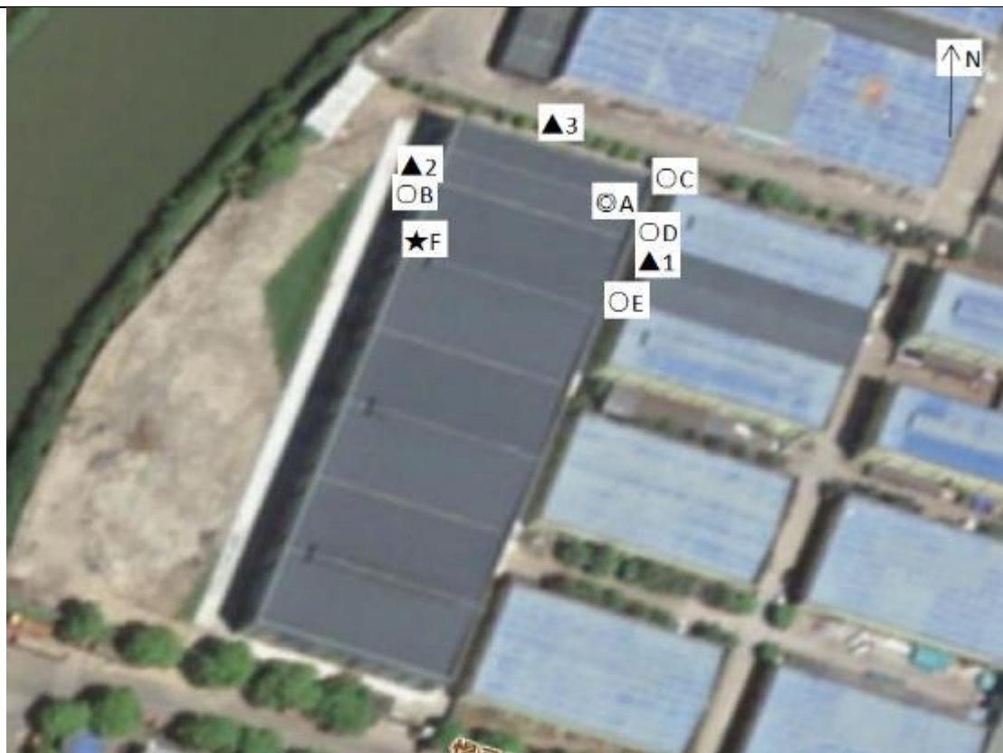
图 6-1 废水、有组织废气、无组织废气、噪声检测采样点位
